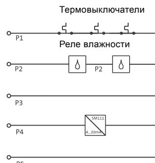
Рис. 26 Исполнение 2 с датчиками/взрывозащищенное (Ex) исполнение 2 с датчиками
